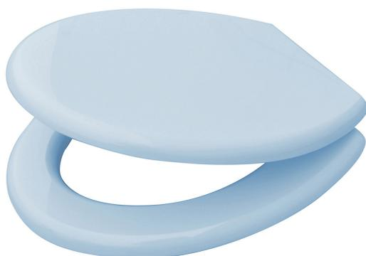
Lunghezza: cm 33,5-39; Larghezza: 27,3; interasse cerniere cm 7-17,5 mod. con cerniere regolabili tipo A. Sedile in legno stabilizzato, colato in poliestere. Cerniere in ottone cromato e viti di fissaggio in acciaio inox.
