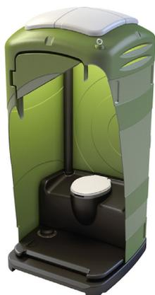
Bagno mobile con wc chimico con seduta e risciacquo con acqua pulita attraverso pompa a membrana azionata a pedale. Fornito di tutti gli accessori standard: appendiabiti, portarotolo, specchio. Largh. 1100 mm x Prof. 1100 mm x H. 2450 mm. Peso 95 kg. Luce porta 600x2000 mm. Vol. accumulo reflui lt 170. Vol. acqua pulita lt 100. Utilizzi 200 c.a. Colore verde - tetto bianco.
